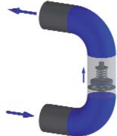
Válvula by-pass integrada entre el envío y retorno del aire
