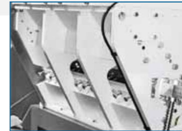
Cámara de molienda ensamblada con primer travesaño antidesgaste
