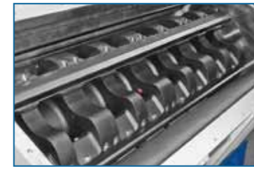
Configuración de corte en tijera para máquinas de 3 y 5 cuchillas
