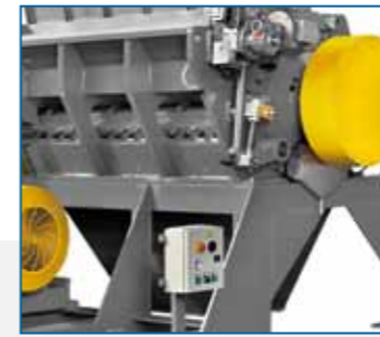
Abertura tolva con gato motorizado, cuadro eléctrico a bordo
