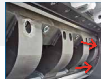
Discos rotativos integrados en el rotor y anillos de contención Discos fijos en la cámara (opcional)
