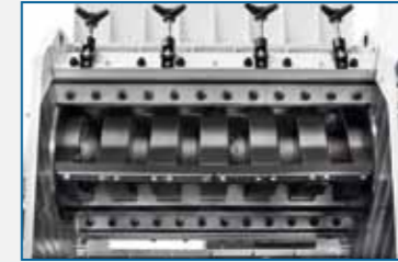
Configuración de corte en flecha para máquinas de 7 cuchillas
