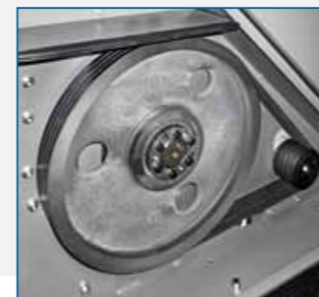
Castillos para el ajuste de la polea motriz y volante Polea y volante según plano para elevada inercia
