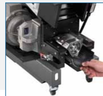
Cuchillas, contracuchillas y rejilla antidesgaste standard
