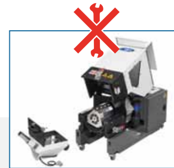
Abertura con tres ganchos y con un único microinterruptor
