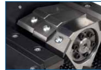
Cuchillas desechables fijadas con una solo tornillo, contracuchillas ajustables
