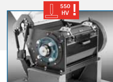
Cámara de molienda en versión antidesgaste
