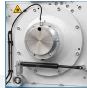
Abertura portarrejilla con cilindro de gas
