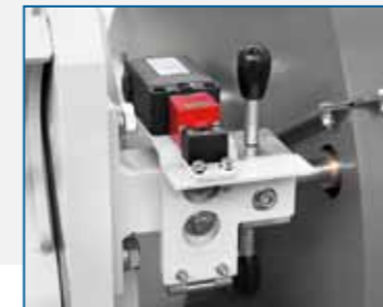
Dispositivo de bloqueo rotor para mantenimiento
