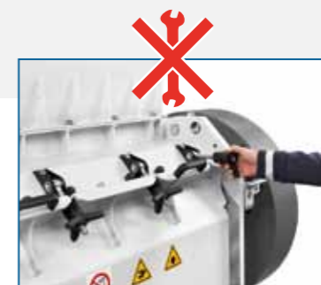
Acceso sin herramientas a las partes principales de mantenimiento
